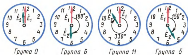
Рис. 2.2. Сравнение положения стрелок часов с обозначением групп соединения
